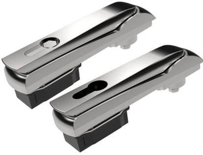
Flacher Schwenkhebel aus säurefestem Edelstahl 316. Für 40 mm Profilzylinder oder mit Werkzeugschlosseinsatz. Ausführung als „Turn-to-latch“, d. h. die Tür wird durch Drehung des Schlüssels verschlossen.
